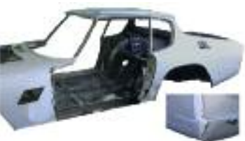
Entlackung einer Aluminium- karosserie inkl. Entfernung der Spachtelmasse
